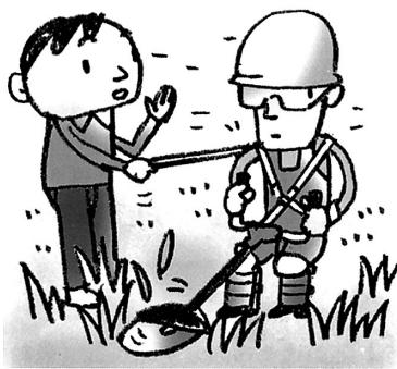
回転する刃による負傷、欠けた刃先や小石などの飛散物による負傷がほとんどです。事故防止には、飛散防止カバーの装着、保護具の着用、特に刈り刃の適正使用が重要です。
