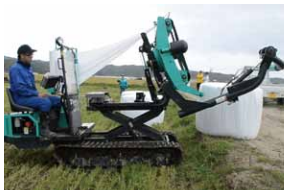
◀ 専用機でラッピングし、 圃場から搬出して発酵させます
