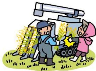
対策……コンバインは大型になるほど死角が増え、特に後方は確認が困難になります。エンジン始動時や作業再開のときはブザーを鳴らし、一呼吸置いて補助者が安全な位置に移動したことを確認してからスタートさせましょう。バックモニターの設置も有効です。補助者は機械との距離を十分に開けて作業しましょう。
