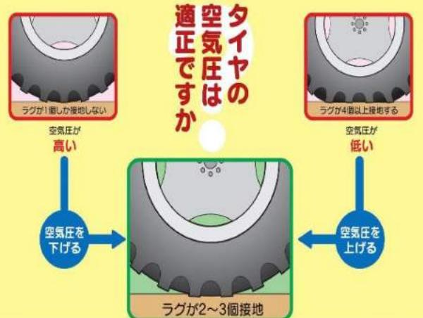
ラグが2～3個設置する適正な空気圧に設定し、左右の空気圧は、必ず揃えます。
