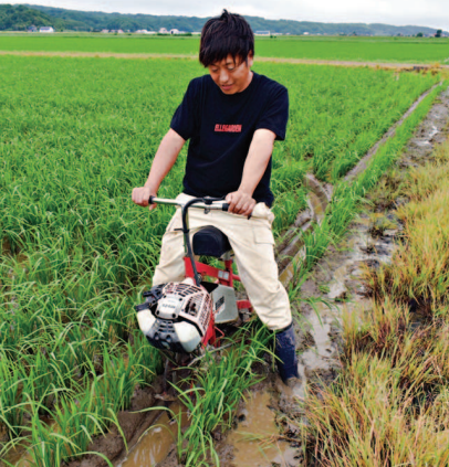
乗用溝切機で水田に溝を切る作業の様子
